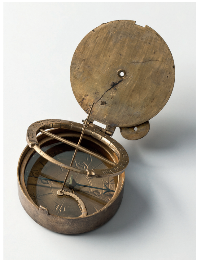
Abb. 8 Stuttgartar Büchsen Sonnenuhr des 15. Jahrhunderts. Das Gerät im aufgeklappten Zustand mit funktionsbereit arretiertem Schattenwerfer.
