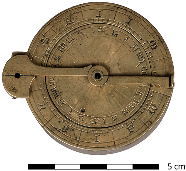
Abb. 7 Stuttgartar Büchsen Sonnenuhr des 15. Jahrhunderts. Links: Das Instrument im geschlossenen Zustand, das Nokturnal am Deckel zeigend. Rechts: Halb geöffnet, den Schließmechanismus mit dem in einen Haken einrastenden Zeiger des Nokturnals demonstrierend.
